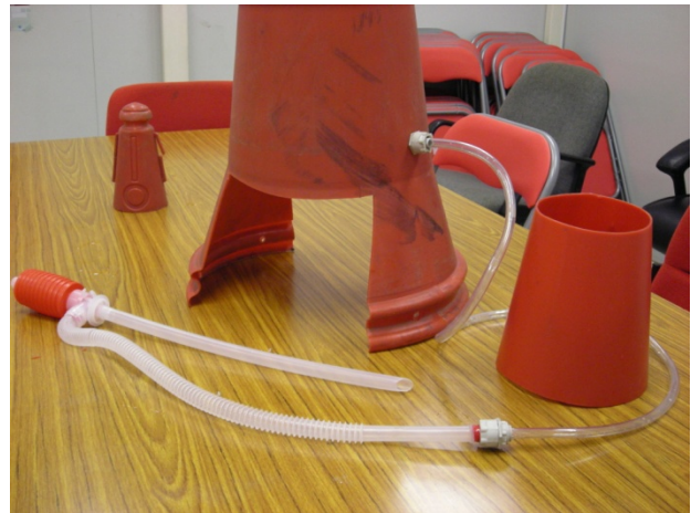
反鏟挖土機的噴水漏斗
