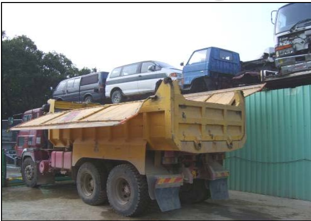
運泥車的機動蓋掩具有環保和安全效益
