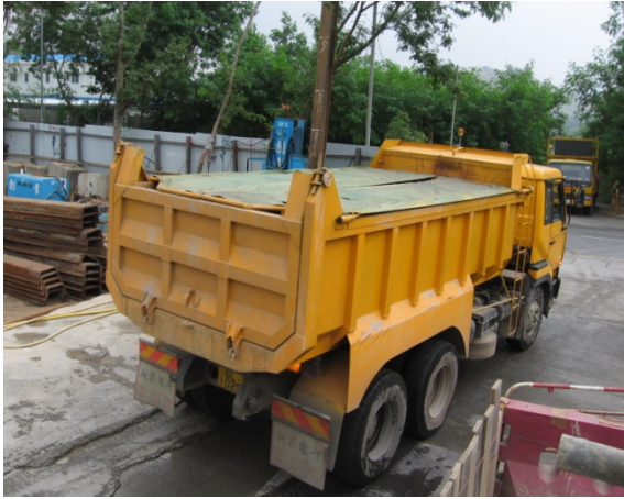
蓋好泥頭車上易生塵埃的負載物品，以避免在運輸過程中排放塵埃
