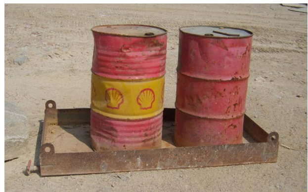
在滴水盤上的化學品的圓桶
