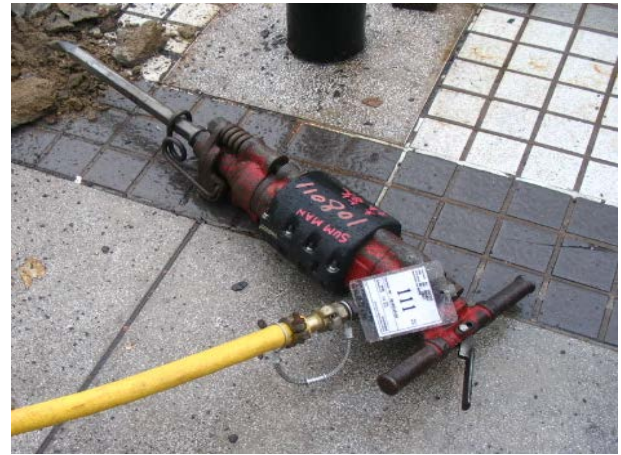
附噪音標籤的手持撞擊式破碎機
