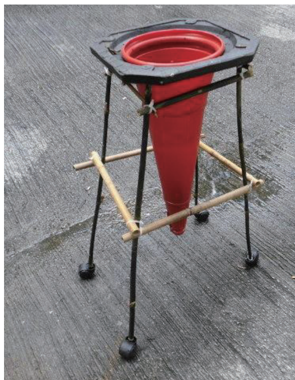
混凝土護養裝置
