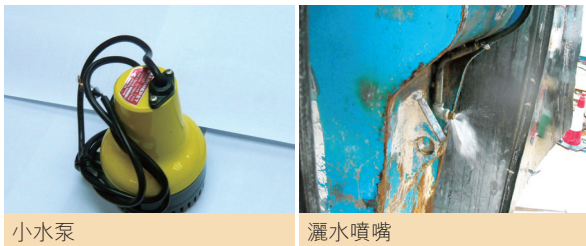
備有灑水系統的液壓破碎機
