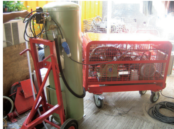
空氣壓縮機的組裝
